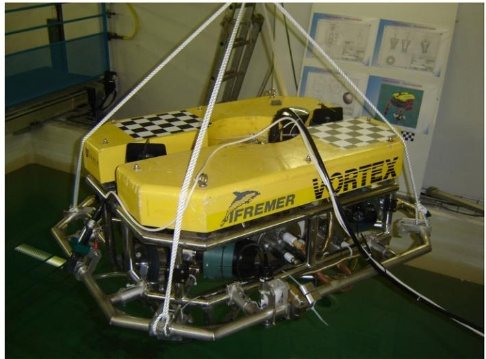
**VORTEX** est opéré en bassin ou en darse. Il peut être téléopéré à l'aide d'un joystick ou être programmé pour exécuter des modes de pilotage automatique à partir des données acquises par ses capteurs embarqués.
