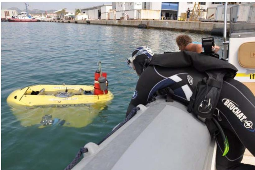
L'engin VORTEX de l'Ifremer durant les premiers tests du projet européen MORPH en juillet 2013 à la Seyne sur Mer. VORTEX est un moyen d'expérimentation et de démonstration en robotique sous-marine. Le système, entièrement modulaire, est configurable soit en ROV (Remotely Operated Vehicle) ou en AUV (Autonomous Underwater Vehicle), idéal pour des projets d'innovation en robotique sous-marine.
